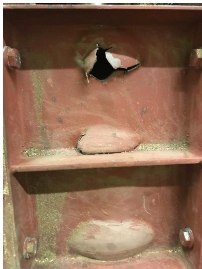
Abgenutzte Sammelschnecke der Holzsnitzelheizung
