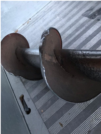
Abgenutzte Sammelschnecke der Holzsnitzelheizung
